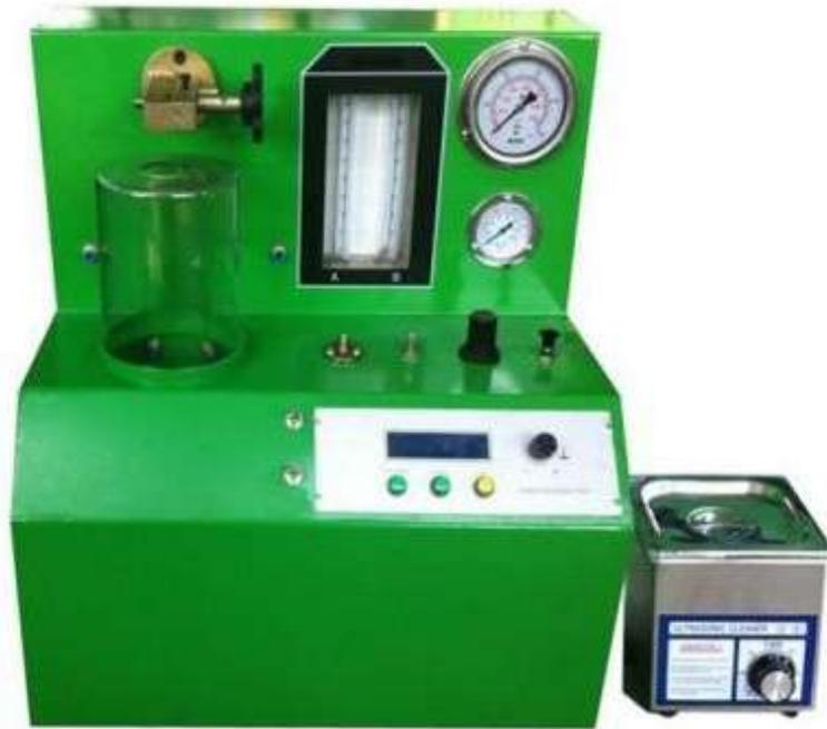
Para probar si el inyector CR todavía está funcionando, conecte un inyector CR a una fuente de combustible de alta presión por una línea de combustible de alta presión y al probador CR por arnés. El probador se establece en modo de inyección continua. Los inyectores CR están en condiciones normales, si es capaz de inyectar combustible bajo las señales de conducción del probador.
