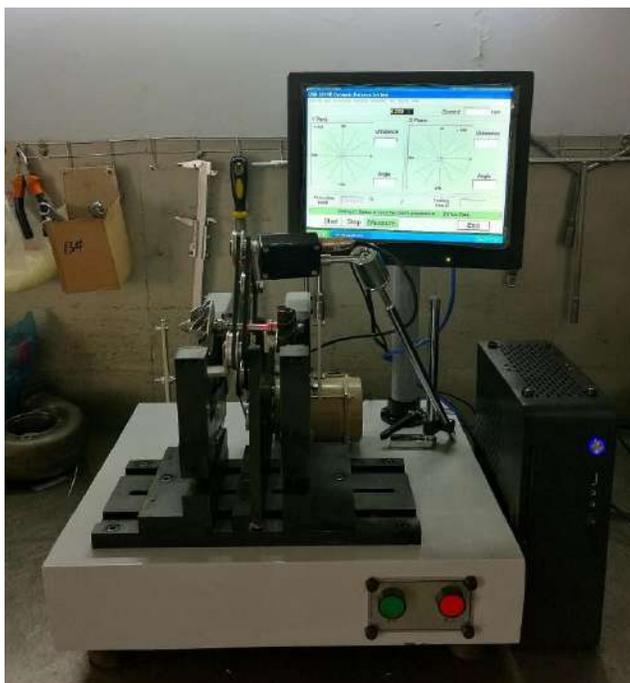
Aplicable principalmente al control de equilibrio dinámico de micro motores, industria de herramientas eléctricas, etc.
