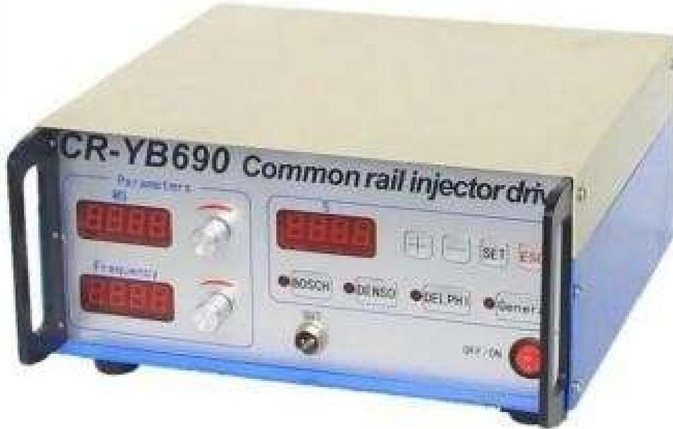
Simuladores de inyector common rail CR-YB690, que pueden probar inyectores electromagnéticos y piezoeléctricos.
