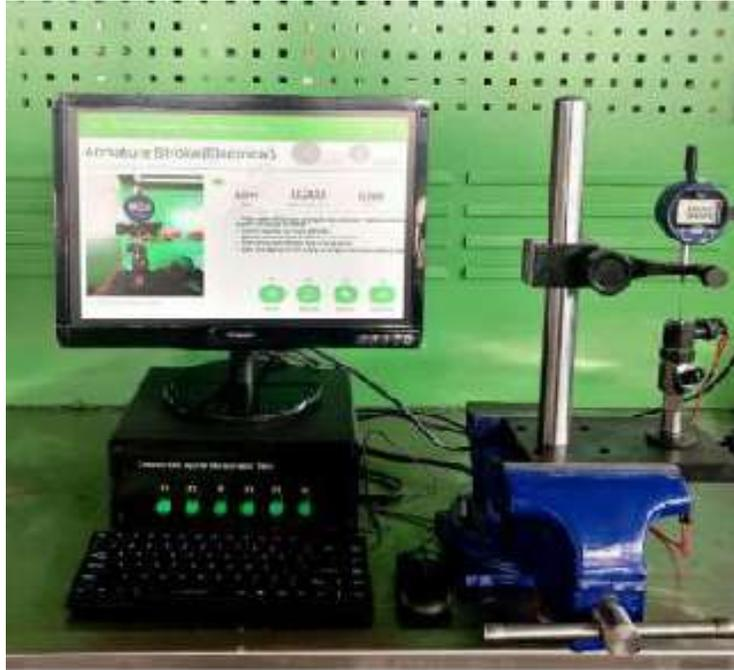
Sistema de medición de carrera del inyector Common Rail, que incluye casi todos los datos estándar de medición de carrera de los inyectores Common Rail en su interior. Adecuado para inyectores BOSCH, CAT, DENSO, DELPHI, SIEMENS, etc.
