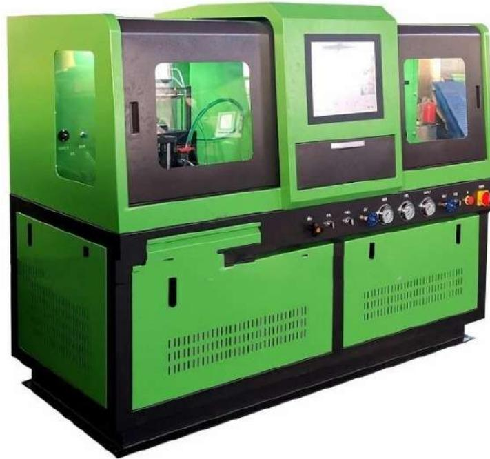
El Banco de pruebas de Common Rail CR966 es el banco de pruebas profesional que se utiliza para probar el sistema de common rail, puede terminar la prueba funcional del sistema de common rail de alta presión.
