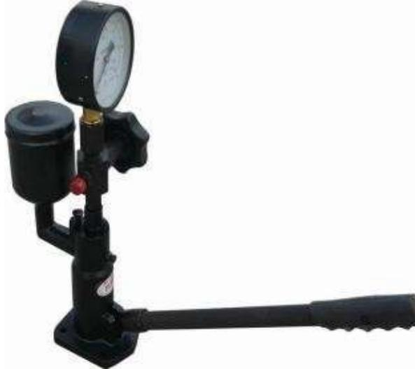
El probador de inyectores de combustible tipo PS-400A es una instrucción especial para la prueba de funcionamiento del motor diesel y es adecuado para las siguientes pruebas de rendimiento.
