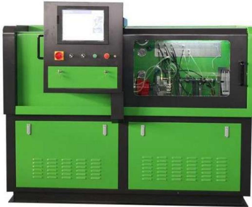
Es principalmente una prueba para bombas e inyectores common rail.
