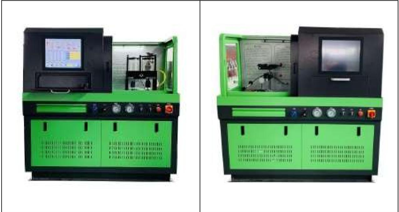
El banco de pruebas Common Rail CAT3100 es el banco de pruebas profesional que se utiliza para probar el sistema common rail y puede finalizar las pruebas funcionales del sistema common rail de alta presión.
