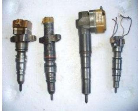
Mejorar el ahorro de combustible y mejorar el rendimiento Medición del suministro de combustible de cuatro inyectores HEUI Prueba de sellado para el asiento superior de los inyectores de la válvula de control de solenoide.
