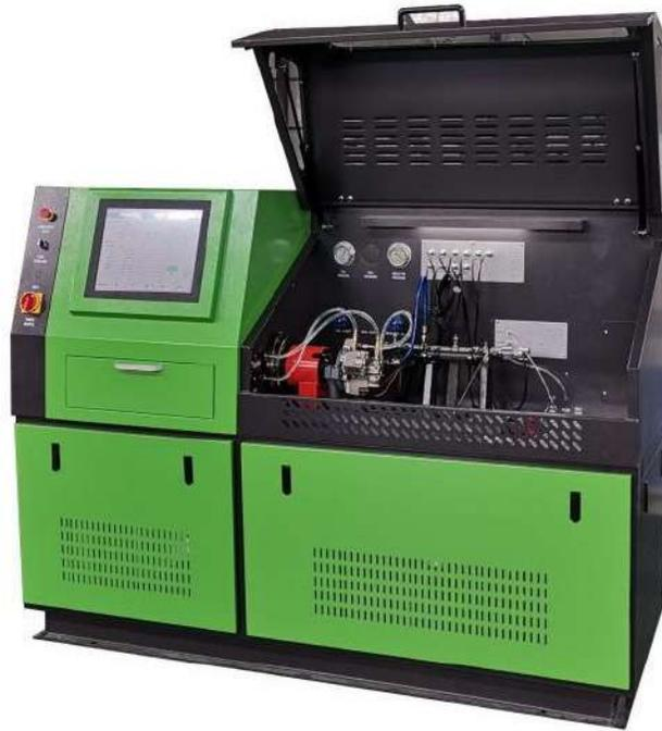
CR718 Banco de prueba de bomba e inyector common rail, usa la importación del sensor de flujo para los medios de medición, puede probar el inyector y la bomba common rail, puede agregar la función EUI / EUP CAMBOX y HEUI.
