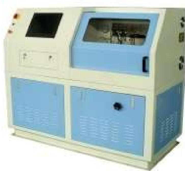
Es principalmente una prueba para bombas e inyectores common rail.
